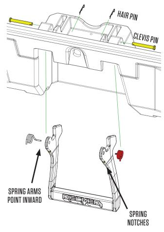
**HELPFUL TIP:** MAKE SURE SPRINGS HAVE THE LONG ARM HORIZONTAL AND SHORT LEG VERTICAL BEFORE INSERTING HANDLE
